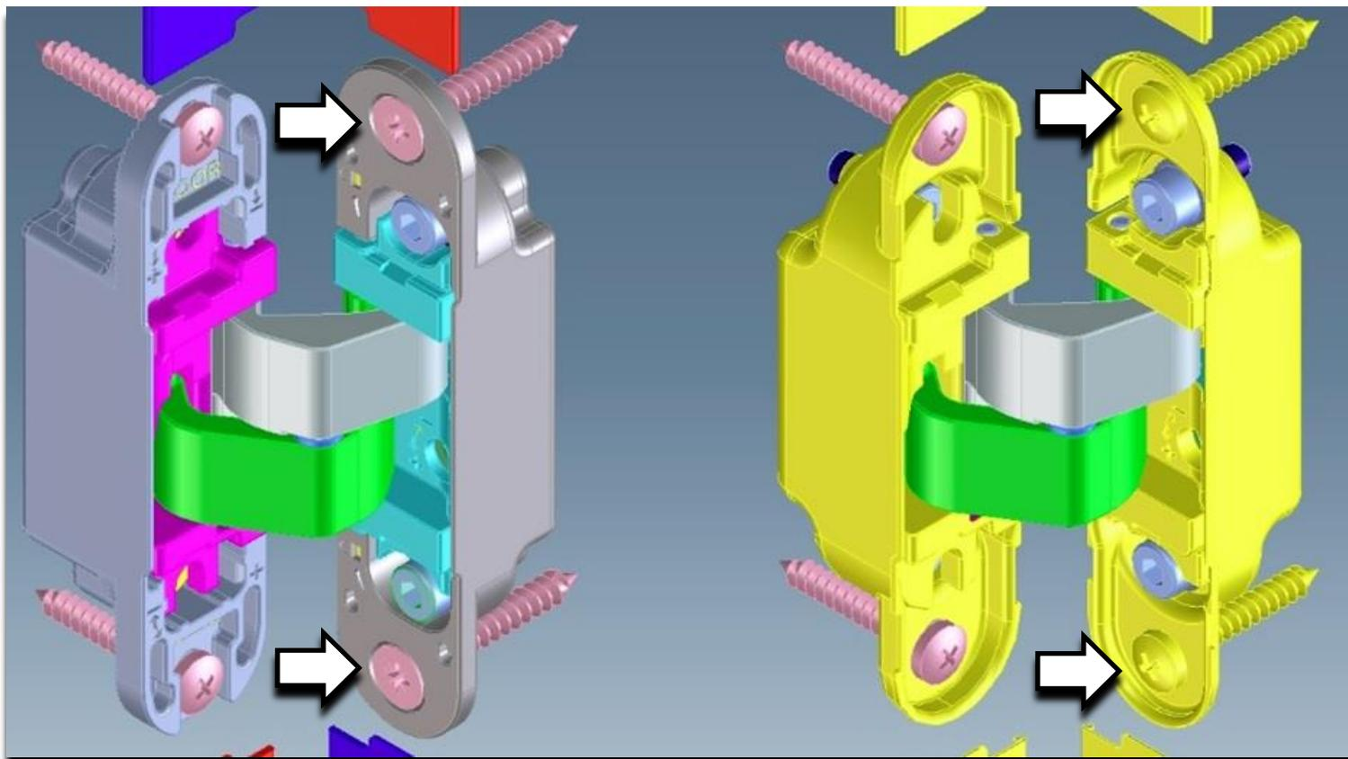
**КРЕПЕЖНЫЕ САМОЕРЗЫ:** Ø4.5мм с круглой плоской шляпкой для крепления корпуса из высокопрочной стали.
